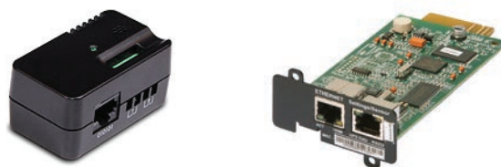
Opcjonalna karta Web/SNMP z detektorem EMP do pomiaru temperatury w zewnętrznych szafach bateryjnych lub na stojakach bateryjnych.
